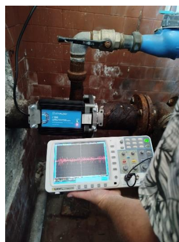
Figura 4: l'oscilloscopio rileva l'impulso Hydropath
