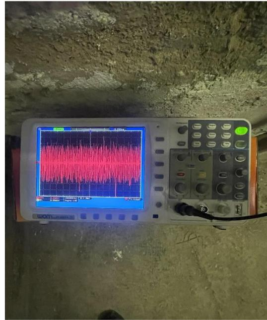
**Figura 3 – Al termine dell'installazione, viene utilizzato un oscilloscopio, per verificare la corretta immissione nell'acqua del segnale Hydropath**
